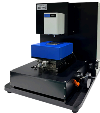
触れた際の粘弾摩擦を評価する試験機
