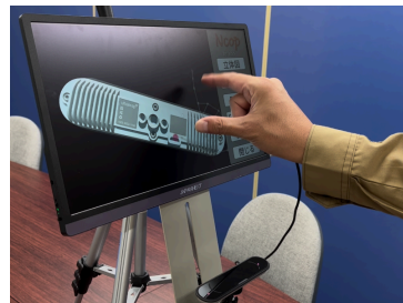
モニターに触れずCADデータを回転、拡大縮小
