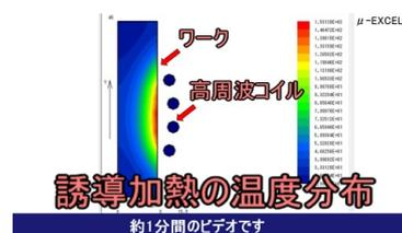
誘導加熱による磁場・温度・時間変化解析
