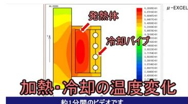
発熱・冷却機構の温度分布・時間変化解析
