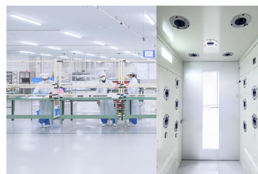
エアシャワーを備えた製造フロア900㎡
