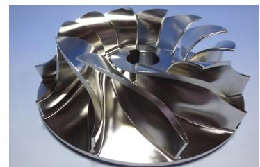
精密機械加工部品例 ステンレス製インペラ
