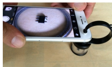
スケールマクロ(マクロレンズとスケールの付いた装置)
