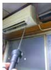
聴診器をベースにした異常音測定器
