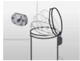
ゴミ箱+ダンパーで飛沫防止
