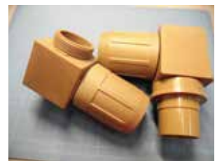
PEEKを使用し、ねじ加工した大型部品です。
